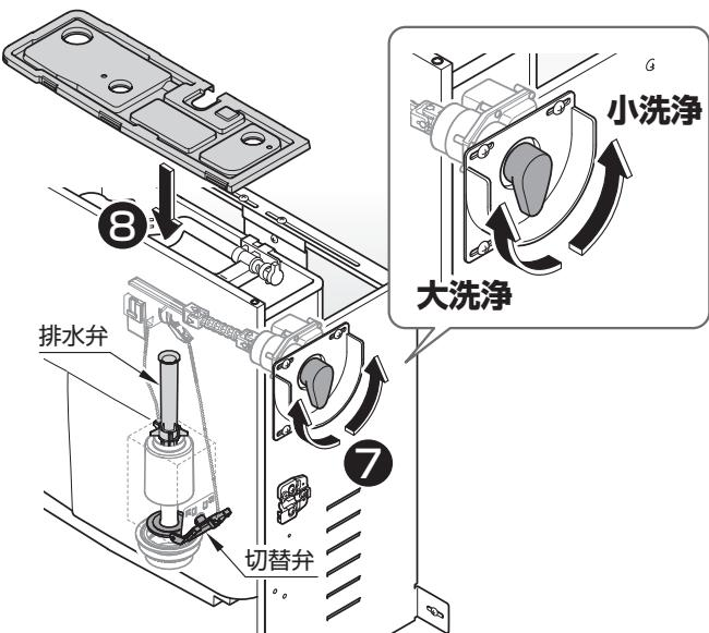
⑨ 洗浄レバー補助カバーを取り付ける
