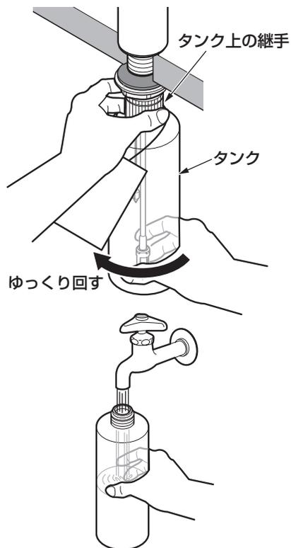
1. タンク上の継手をつかみながら、タンクの底部をつかみ、ゆっくりと回して、タンクを外す。
