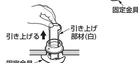
③引き上げ部材を引き上げたまま、ボルト・座金(2本)を固定金具に通し、手締めで4~5回転ねじ込む。
