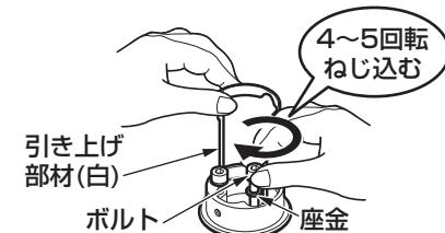
④引き上げ部材・ボルト・座金(2本)を押し下げ、上面施工用アダプターをボルトの方向に当たるまでずらす。
