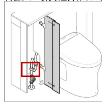
「ワンタッチカプラ式」ウォシュレット用分岐金具部を「ナット式」ウォシュレット用分岐金具に交換
