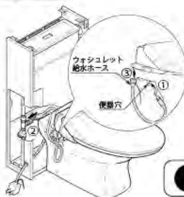
ウォシュレット給水ホースは便器穴を通し、先に分岐金具に接続し、その後ウォシュレットに接続する。
