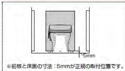
※前板と床面の寸法：5mmが正規の取付位置です。
