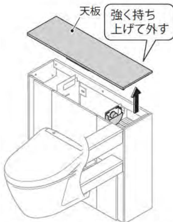
※天板はキャビネットに強力に固定されています。壁のクロスなどに十分気をつけながら取り外してください。
