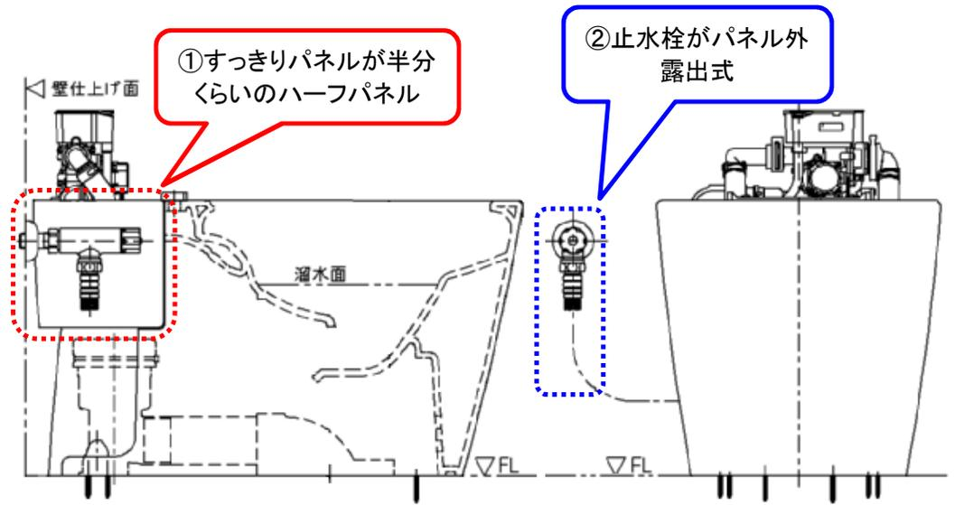
基本リモデル用ですが、こちらは便器を外してみないと断定はできません。ハーフパネル、止水栓露出式でも、排水心200mmの場合（CS966BF/BHF）があります。便器の左側面下奥に貼り付けてある品番ラベルを確認してみてください。
