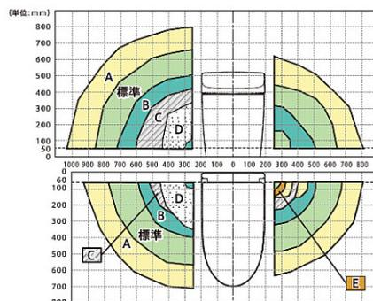
※ E TN111L37は長さ調整用の継手を使用しない場合の範囲を示しています。
