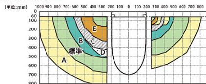
※ E TN111L37は長さ調整用の継手を使用しない場合の範囲を示しています。
