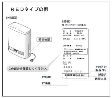
■電気温水器本体<u>正面もしくは側面</u>に貼り付けている製造銘板で、品番を確認してください。 ※製造銘板貼り付け場所は、取扱説明書に記載しています。
