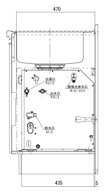
【キッチン右側に設置する場合の最小必要寸法】※下図2点鎖線部
