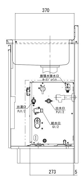
【注記】・電気温水器の満水質量に耐えられるよう、必要に応じてキャビネット底板に補強などの処置を行ってください。
