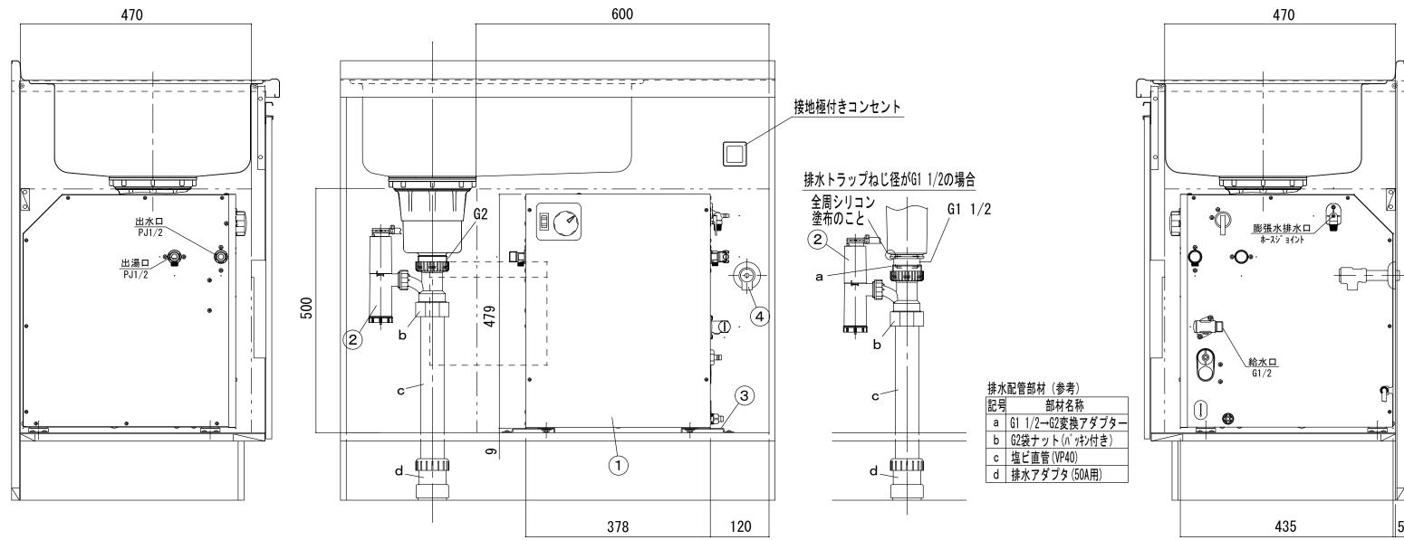
【注記】・電気温水器の満水質量に耐えられるよう、必要に応じてキャビネット底板に補強などの処置を行ってください。
