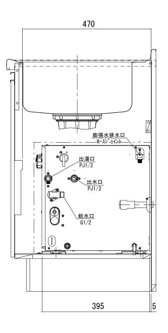
【キッチン右側に設置する場合の最小必要寸法】※下図2点鎖線部
