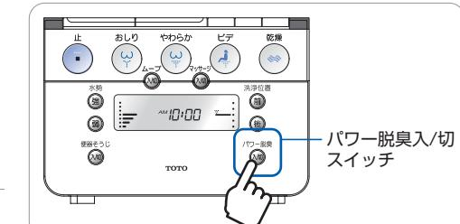
アドバイス 5 オートパワー脱臭が「切」の状態で電池交換をすると、約10分後にオートパワー脱臭は「入」に設定されます。
